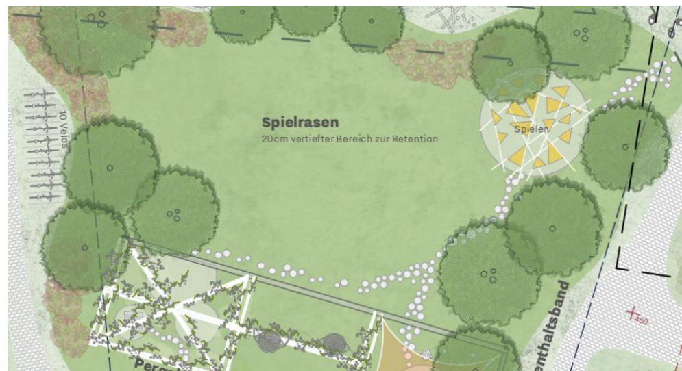
Abbildung 26: Vertiefter Bereich zur Retention auf dem Spielrasen
